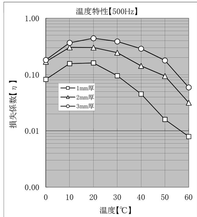
測定方法:JIS G 0602 / 支持法:中央加振法 / 試験片:オバスト梁 / 基材:SPCC-D鋼板(0.8mm)
